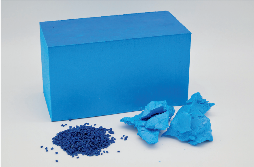
Bild 3, Fallbeispiel 7: Im Rahmen der Herstellung von Transportboxen aus geschäumtem Polyethylen fallen Schaumstoffverschnitte an. © IKK
