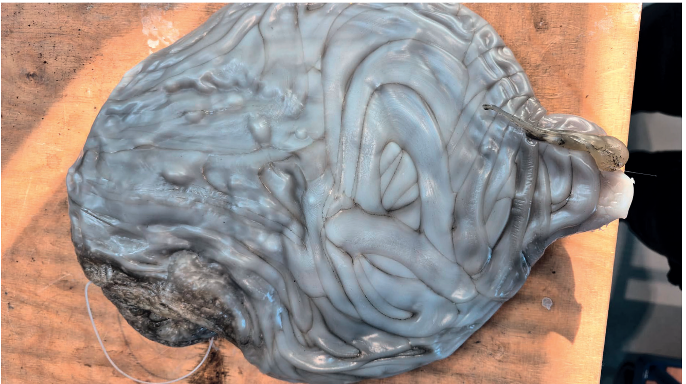
Beim Anfahren einer Profilextrusion entsteht ein Anfahrkuchen. © IKK
